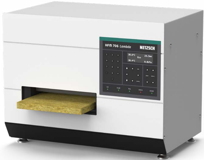
Einsetzen des Referenzmaterials; es können verschiedene Referenzmaterialien verwendet werden.
