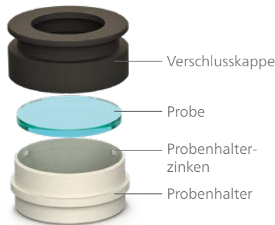
Probenhalteraufbau für runde Proben (ähnliches Set für quadratische Proben)
