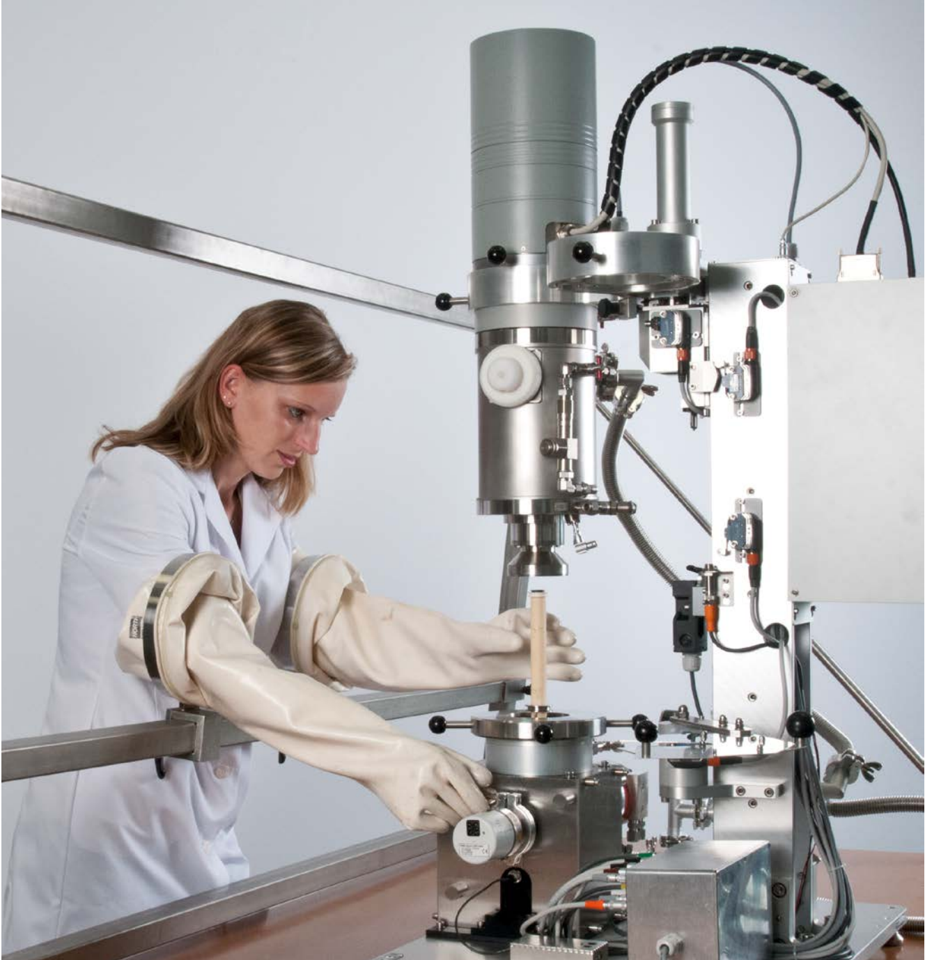
LFA in einer Glovebox (originalgetreue Nachbildung)
