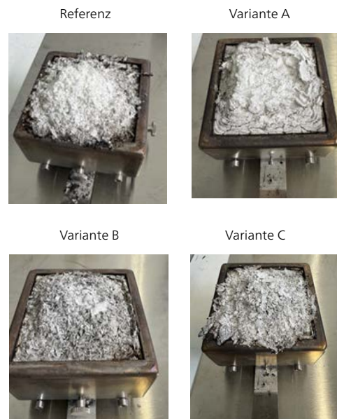
6 PVC-Proben nach der Messung im TCC 918
