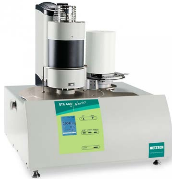
Abb. 1. STA 449 F3 Nevio mit automatischem Probenwechsler
