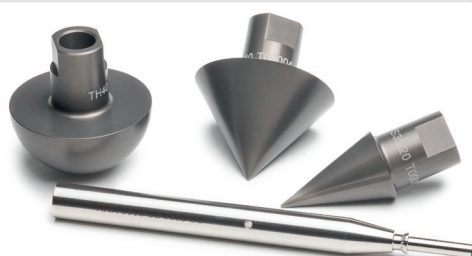
Kinexus テクスチャー解析オプション (3つのテストジオメトリ) (KNX2293) と 上部汎用ジオメトリ M4 (KNX0095)
