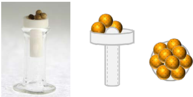
Abb. 6a. Original und 6b+c. Schematische Anwendung des abgeschnittenen \text{Al}_2\text{O}_3 -Tiegels für das A- \text{CaCl}_2 -Komposit-Granulat (gelb)
