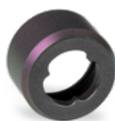
試料ホルダー、直径 10.0 mm; 注文番号 LFA46700B93.013-00
