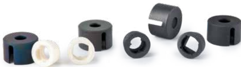
丸形および角形試料 (直径10 mm) のためのセンタリングコーンおよびキャップ;センタリングコーンはAl 2 O 3 (白) およびグラファイト (灰色) 製;キャップはSSiCおよびグラファイト製。
