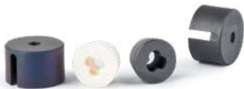
直径6 mmの試料用センタリングコーンおよびキャップ;センタリングコーンはAl 2 O 3 (白)およびグラファイト (灰色) 製;キャップはSSiC (左) およびグラファイト (右) 製。
