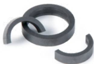
グラファイト製 繊維試料用試料ホルダー 注文番号：6.256.1-93.6.00 なお、Al 2 O 3 製 (注文番号：6.256.1-93.3.00) も用意されています。
