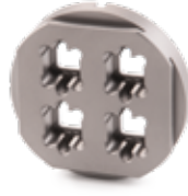
標準試料ホルダー、8.0 mm x 8.0 mm, 注文番号 LFA46700A90.032-00
