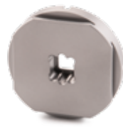
標準試料ホルダー、8.0 mm x 8.0 mm, 注文番号 LFA46700A90.044-00
