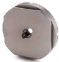
標準試料ホルダー、直径 6.00、 注文番号 LFA46700A90.025-00
