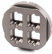
標準試料ホルダー、10.0 mm x 10.0 mm, 注文番号 LFA46700A90.031-00
