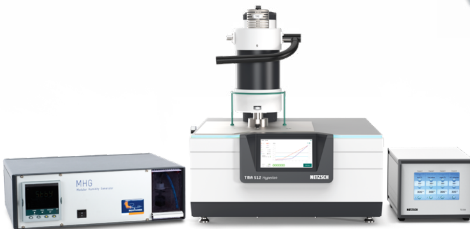
Feuchtgenerator, angeschlossen an die TMA 512 Hyperion ®
