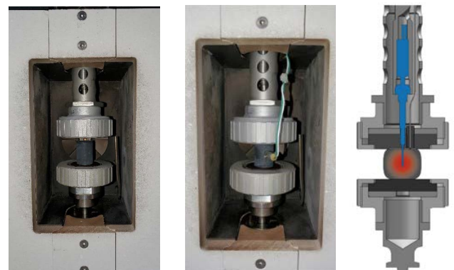
1 (a) Der Basis-Probenhalter für Flexometertests. (b) Der gleiche Basis-Probenhalter für Flexometertests mit einem zusätzlichen horizontalen Nadelthermoelement, eingebracht in eine Gummiprobe. (c) Der zweite Probenhalter für Flexometertests ist mit einem vertikalen Thermoelement für eine präzise Bestimmung der Temperatur im Probeninneren nach der Messung ausgestattet.
