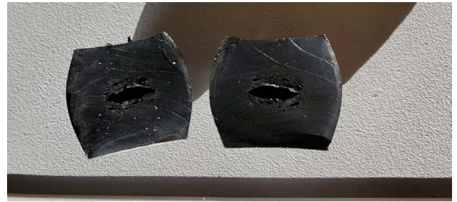
5 Nach den HBU-Experimenten wiesen die Gummiprobe eine deutliche thermische Verfestigung auf. Außerdem waren Hohlräume in der Mitte der Proben deutlich erkennbar.
