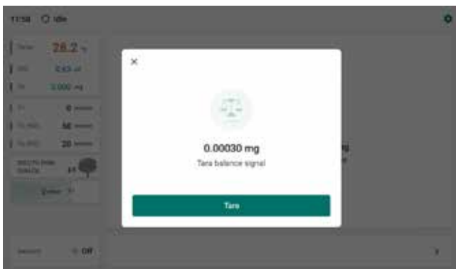
PC にログインせずに 天秤のテアシグナル (風袋) を調整
