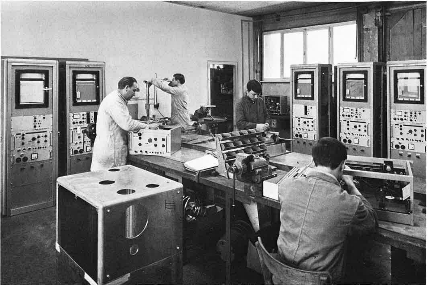
Blick in einen Teil der heutigen Fertigungsräume der Netzsch-Gerätebau-GmbH, Montage von Registrier- und Steuerschränken und Temperatur-Steuergeräten.
