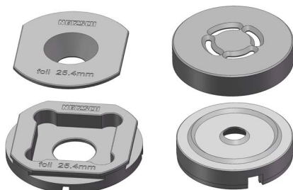
1 Probenhalter für through-plane (links) und in-plane Messungen (rechts) von dünnen Folien
