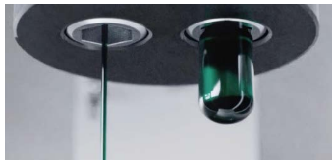
Abb. 3. Links: Das Design der FreeFlow -Düse verhindert jegliches Ankleben. Rechts: Die gleiche Probe, gemessen mit der konventionellen Düse.
