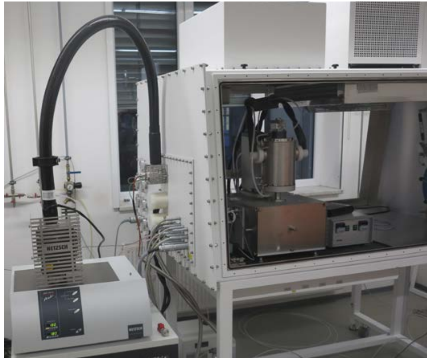
Abb. 1. STA 449 F1 Jupiter® Glovebox-Ausführung mit beheizter Durchführung zur Kopplung des QMS 403 Aëolos®
