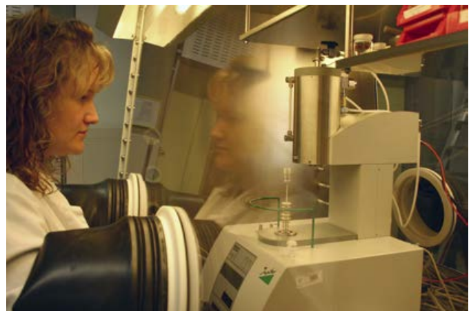
Abb. 6. STA 449 C Jupiter* in einer Materialschutz-Glovebox am Max-Planck-Institut CPFS Dresden (Foto aus "Picturebook 5", © M. Braun Inertgas-Systeme GmbH, Garching, Deutschland)
