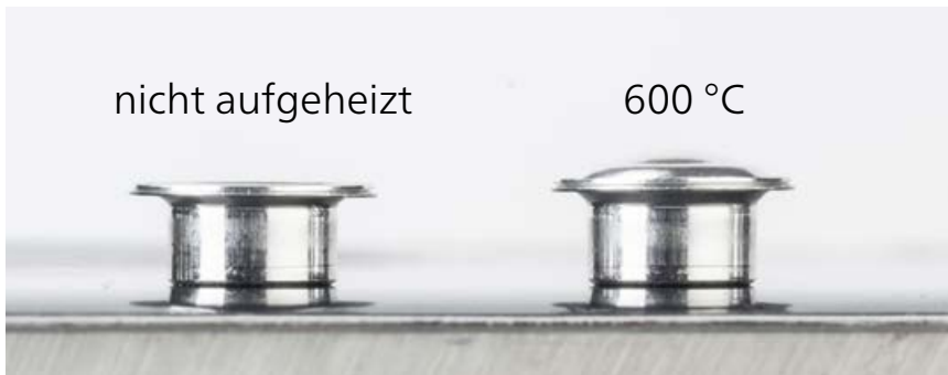
Abb. 2. Hermetisch verschlossene Concavus ® Tiegel bei RT und 600 °C
