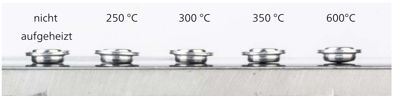
Abb. 1. Hermetisch verschlossene Standard-Aluminiumtiegel bei verschiedenen Temperaturen
