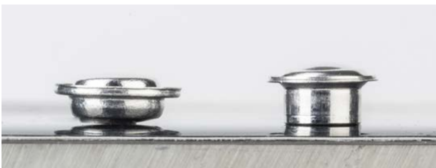
Abb. 3. Vergleich der beiden Tiegelarten nach dem Aufheizen auf 600 °C
